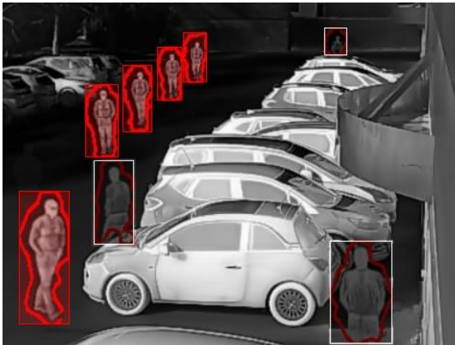
Figure 1: Contours des objets en mouvement : corrects en rouge ; incorrects en blanc (car incomplets, touchant le bord ou contenant une ombre).
